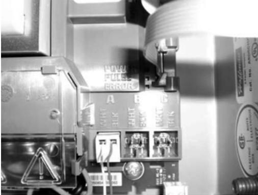
**Fig. 11. Polaridad del sensor. Si el sensor de corriente está instalado correctamente, el indicador LED de error está apagado. Si el indicador LED de error está encendido, desconecte el enchufe gris e invierta el conector de entrada. Si la indicación de "Error del sensor" desaparece, marque correctamente. Repita el procedimiento para todos los sensores.**
