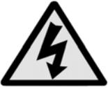
Esta etiqueta indica la existencia de peligro de descarga eléctrica en el lugar o área donde se encuentra la etiqueta. Antes de continuar, se debe desconectar la energía de la RED ELÉCTRICA y se debe consultar el manual para obtener información de seguridad.
